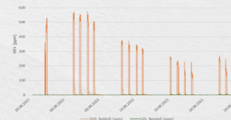
H 2 S-Konzentrationen in der Rohluft und Reinluft der mobilen Abluftbehandlungsanlage
