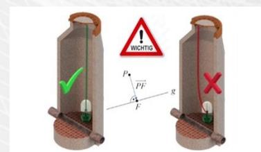
8. Positionierung des Befestigungspunktes des Seils: **der Befestigungspunkt des Seils muss genau über der Standardposition der Rattenkugel liegen, nicht daneben.**
