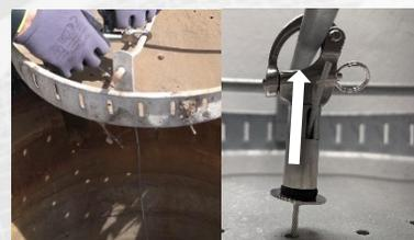
6. Schmutzfänger wieder einsetzen und Seil von unten in das Seilverschluss einfädeln. Zum Entriegeln der Seildurchführung Druck auf die untere Scheibe ausüben.
